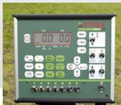
Стандартний комп'ютер Spray фірми Muller Elektronik призначений для автоматичного утримання заданої норми виливу незалежно від швидкості руху
