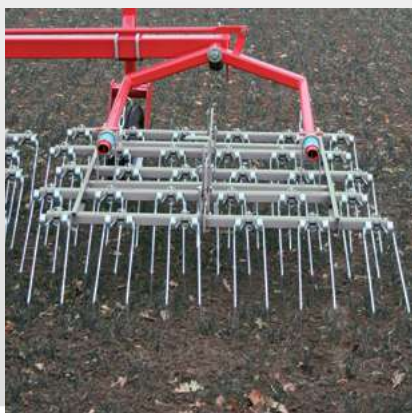
Робоча секція завдяки конструкції підвіски прекрасно копіює рельєф поля
