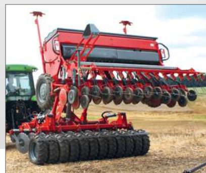
Навіска сівалки - дана опція використовується для створення компактного ґрунтообробно-посівного агрегату
